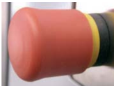
Arrêt d'urgence désenclenché
